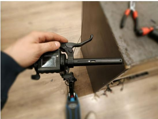
Etape 9 : Remettez la poignée en place et la goupille. Pour l'insérer au travers du ressort, utilisez un outil de type crochet de couturière, tirez fort et descendez la goupille jusqu'au bout pour qu'elle rejoigne son emplacement.
