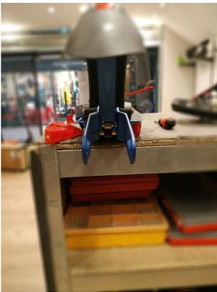
Etape 6 : Mettez la roue en place sur la fourche et faites le serrage des écrous et de la vis du tambour
