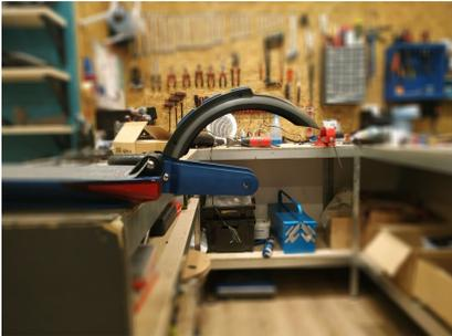
Etape 2 : Agrandir le passage de l'axe avec une mèche à métaux de 8mm, créez le perçage pour la vis du tambour avec un foret de 5mm
