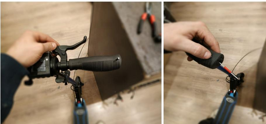
Etape 10 : Mettez le câble de frein comme suit, sans le ressort pour permettre le passage. En premier dans la gâchette, faites le serrage de la molette grise, puis passer le câble dans le collier de serrage du haut en dévissant le système de serrage complètement, remettez le en place, puis passez le câble dans l'anneau passe câble moteur, et les réflecteurs avant et arrière. Mettez le ressort en place et faites le serrage de l'écrou
